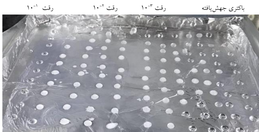
شکل ۴- آزمون انجماد قطره ای سوسپانسیون باکتری نوع وحشی و جهش یافته P. syringae در حمام سرد شده توسط اتانول و یخ در دمای 7^{\circ}\text{C} -، قطرات یخ زده ظاهری کدر نسبت به قطرات یخ نرزه دارند. شاهد آب مقطر است. سری رقت اول، سری رقت دوم و سری رقت سوم مربوط باکتری تیپ وحشی دارای فعالیت هسته یخ است. باکتری جهش یافته ( سمت راست ) فاقد ژن هسته یخ و فاقد توانایی در ایجاد کریستال‌های یخ.
